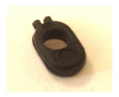
las copas de apoyo y los cojinetes de plástico pueden ser retenidos tal y cual como que se encuentran en los coches de caja, o podran ser sustituidos por tornillos de cabeza hexagonal M2 para un control más preciso.
