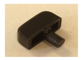
La posición del eje está determinada por dos cojinetes de plastico colocados en el anillo de retención del eje mismo:
