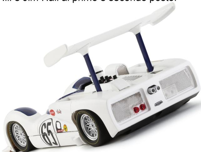
L'alettone era montato sui portamozzoni posteriori, permettendo di applicare il carico aerodinamico direttamente sulle gomme, senza comprimere le sospensioni.
