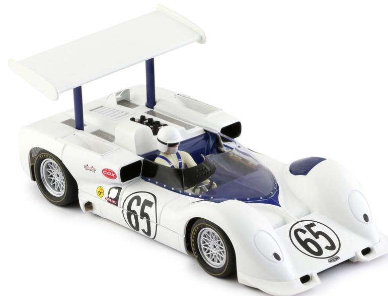
Nel 1966 la Chaparral introdusse la 2E nelle gare della serie Can-Am. Con il suo alettone, un'aerodinamica intelligente ed i radiatori posteriori, la vettura anticipò i concetti che sono alla base delle auto da corsa contemporanee.
